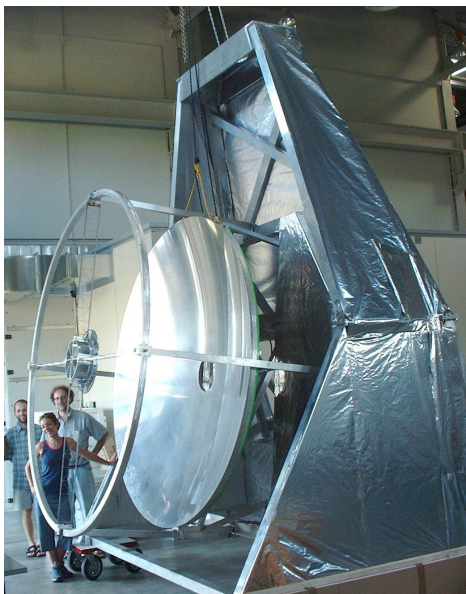
Fig.2: Il telescopio da pallone stratosferico OLIMPO, realizzato da una collaborazione internazionale coordinata da Silvia Masi, dell’ Università La Sapienza, e finanziato da La Sapienza e dall’ Agenzia Spaziale Italiana. Il telescopio ha uno specchio primario da 2.6m di diametro, e un sistema di più di 100 rivelatori criogenici. Lo strumento vola ad una quota di 40 km appeso ad un enorme pallone stratosferico, ed è dedicato all’ osservazione di ammassi di Galassie.
