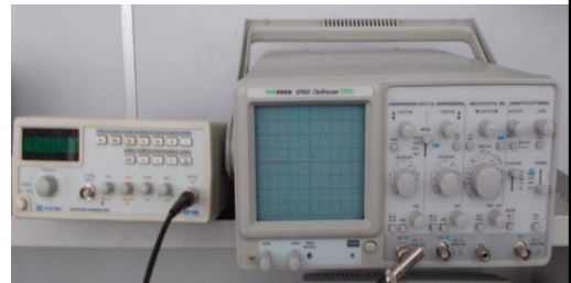
Oscilloscopio analogico collegato con uscita a 50 Ohm del Generatore di funzioni
