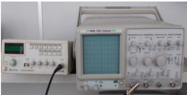
Oscilloscopio analogico collegato con uscita a 50 Ohm del Generatore di funzioni
