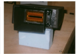
Figura 3.24: Fotografia della scatola dei sensori (si vede l'array di 46 fotodiodi) con il filtro Schott OG530 montato. Questo è il filtro scelto per il volo di Kitea per utilizzare il numero di stelle visibili nelle sue direzioni.
