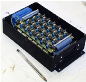
Figura 3.17: Foto della scatola dei sensori con l'elettronica di preamplificazione utilizzata nel volo di Tropicus.
